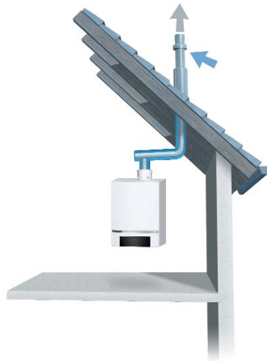
Raumluftunabhängige Aufstellvariante mit Rohr-in-Rohr-Kunststoff-Abgassystem
