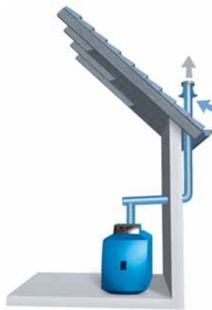
Raumluftunabhängige Aufstellvariante mit Rohr-in-Rohr-Kunststoff-Abgassystem
