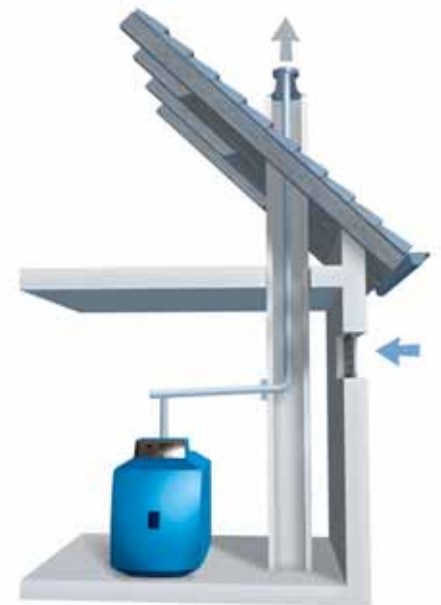
Raumluftabhängige Aufstellvariante mit eingezogenem Abgasrohr im Schornstein ( nicht geeignet zur Luftansaugung)
