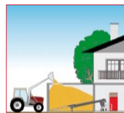
Befüllung des Lagerraumes mit Frontlader
