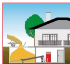
Raumaustragung mit Steigschnecke
