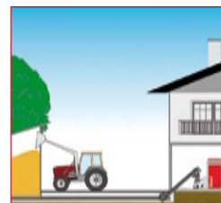
Länge des Schneckenkanals über 15 Meter möglich (mehrere Bauteile)
