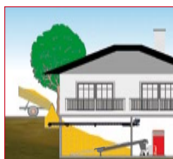
Raumaustragung mit Steigschnecke u. Hackgutförderung an der Decke zur optimalen Befüllung des Lagerraums
